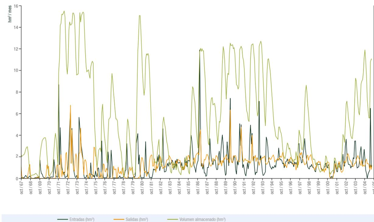
Figura 3.2. Embalse de Guadalest: entradas, salidas y volumen almacenado entre octubre de 1967 y febrero de 2005
