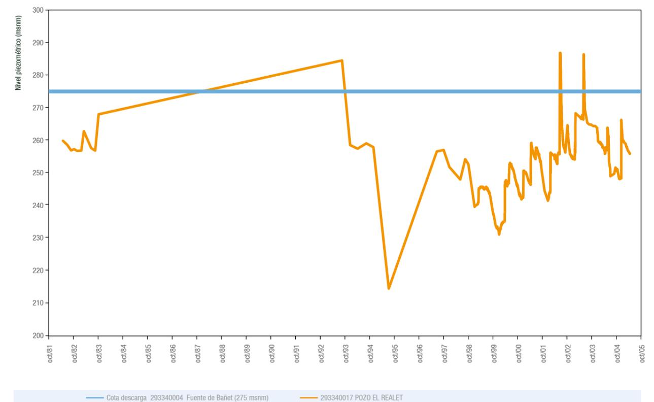
Figura 7.15. Evolución temporal del nivel piezométrico en el sondeo Realet y relación con la cota de descarga de la Fuente de Bañet
