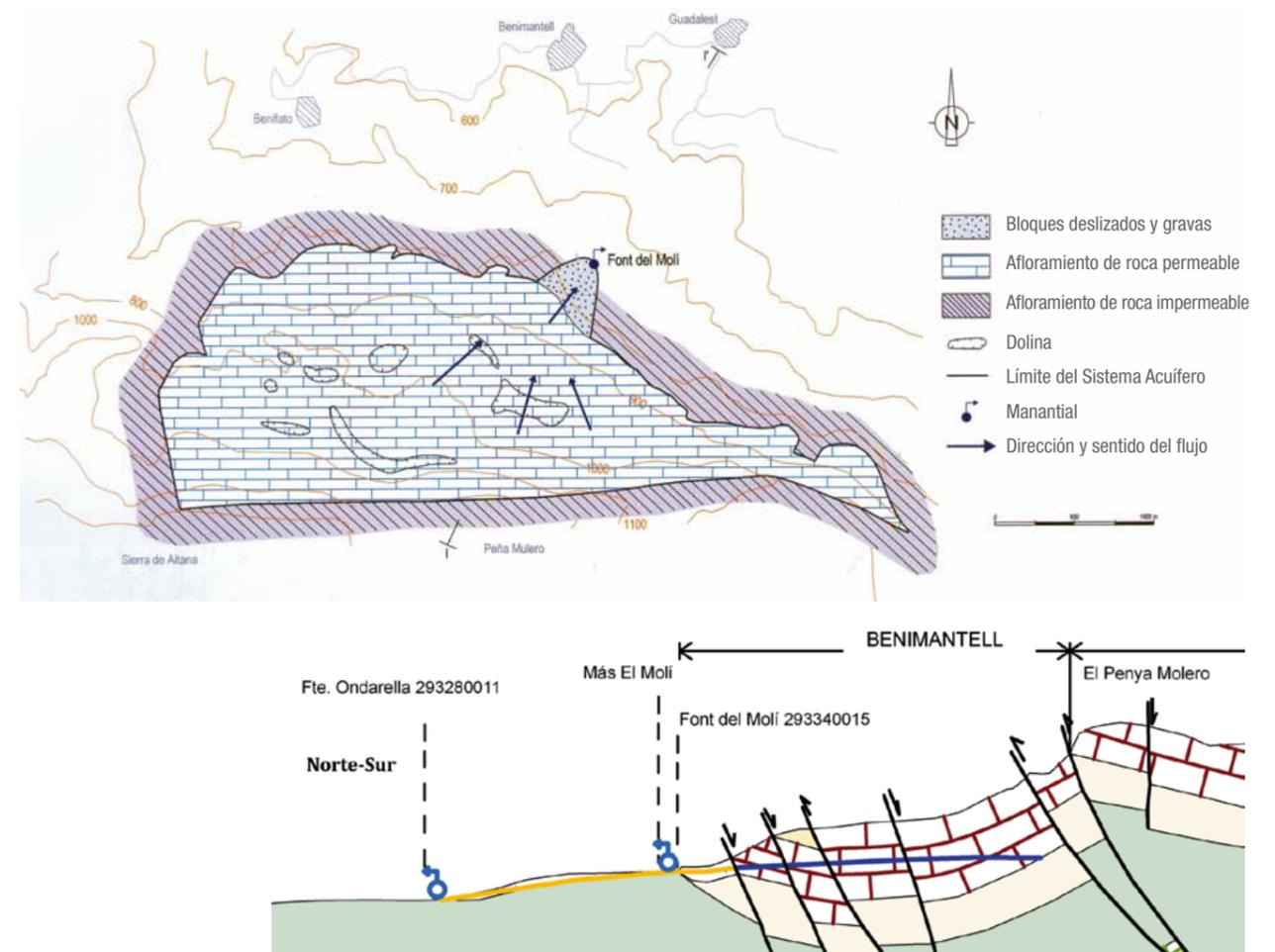
Figura 7.4. Corte hidrogeológico esquemático del acuífero Benimantell (B-B' indicado en el Mapa de acuíferos).
