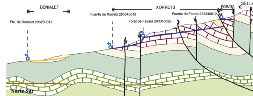
Figura 7.7. Corte hidrogeológico esquemático del acuífero Xorrets y relaciones con los acuíferos de Forata y Sella (corte D-D' indicado en el Mapa de acuíferos)
