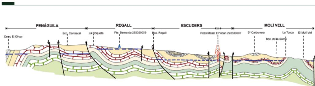
Figura 7.16. Corte hidrogeológico esquemático del acuífero Escuders y relaciones con Penàguila, Regall y Molí Vell (corte H-H' indicados en el Mapa de acuíferos).
