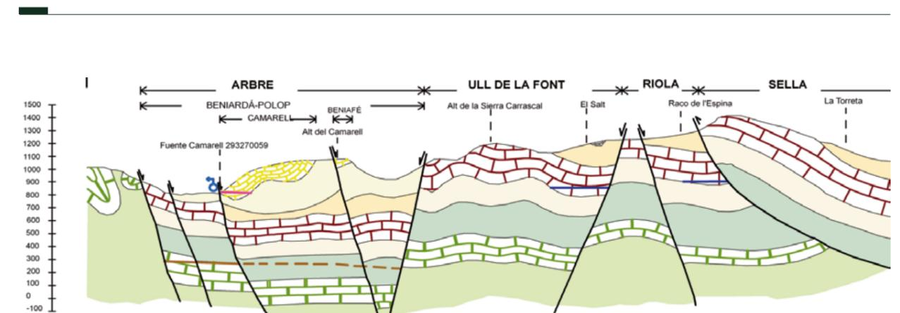
Figura 7.20. Corte hidrogeológico esquemático del acuífero Ull de la Font y relación con Arbre, Riola y Sella. (corte J-J' indicado en el Mapa de acuíferos). (corte H-H'-H'' indicado en el Mapa de acuíferos).
