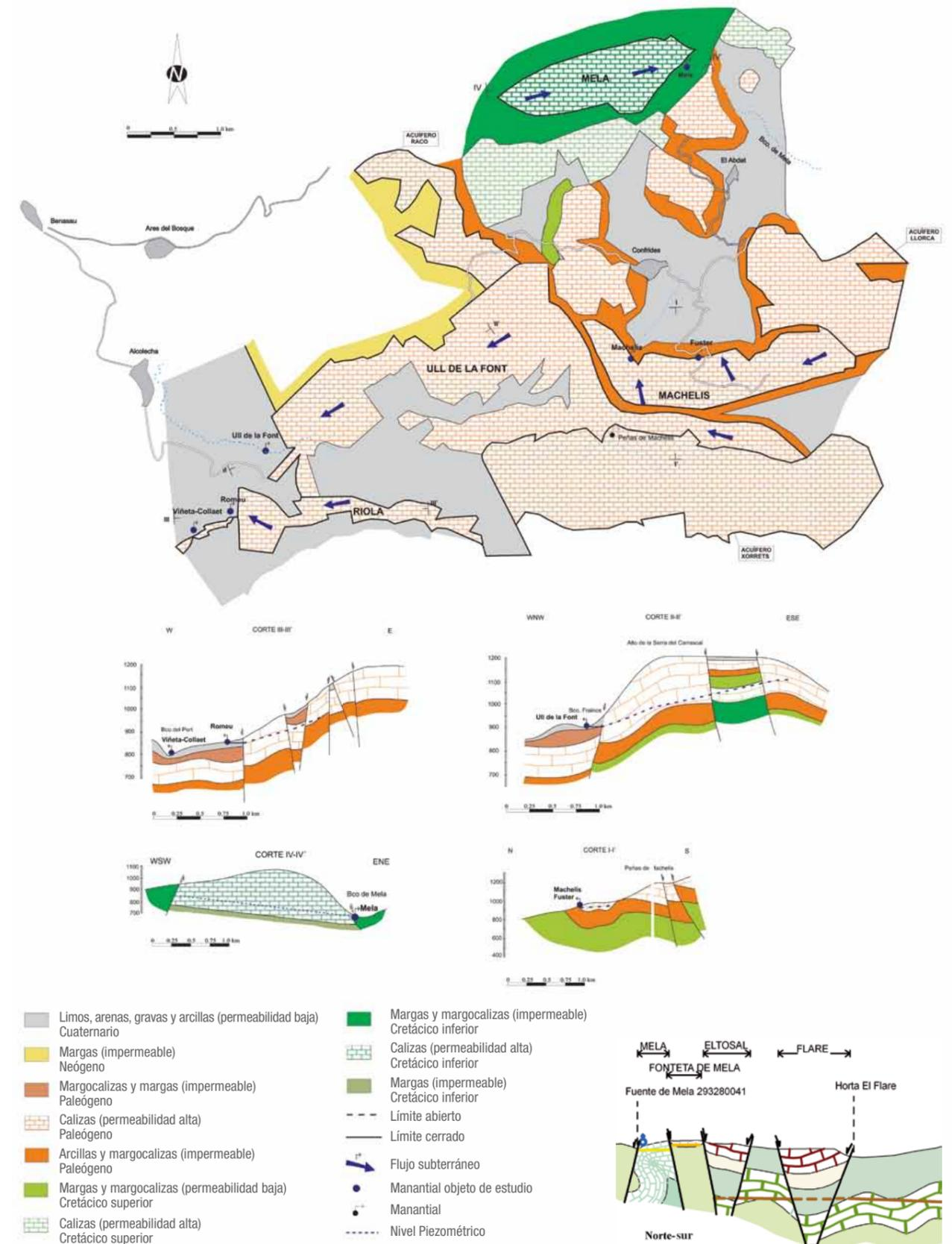
Figura 7.5. Corte hidrogeológico esquemático del acuífero de Mela y relaciones con otros acuíferos del entorno (corte C-C' indicado en el Mapa de acuíferos).
