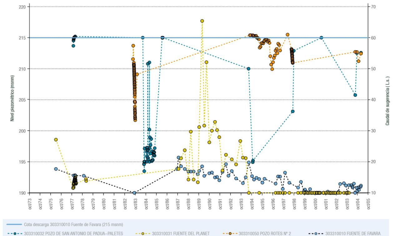
Figura 7.8. Evolución de niveles piezométricos y caudales de puntos de agua del acuífero Favara
