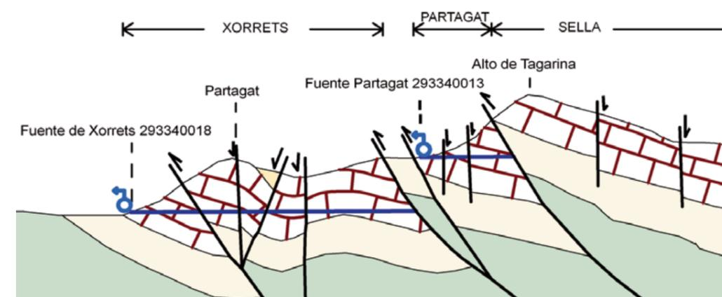
Figura 7.21. Corte hidrogeológico esquemático del acuífero Partagat y relación con Xorret y Sella (corte k-k' en el Mapa de acuíferos)
