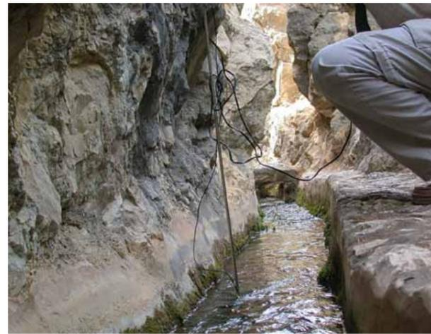
Aforo en una de las derivaciones para riego
