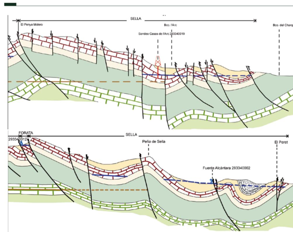
Figura 7.12. Cortes hidrogeológicos esquemáticos del acuífero de Sella (cortes F-F' y G-G' indicados en el Mapa de acuíferos)
