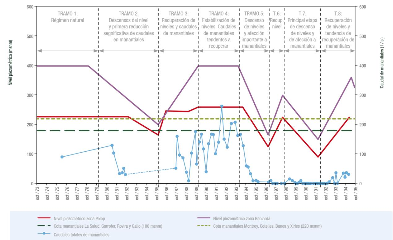
Figura 7.3. Esquematización de la evolución temporal de niveles piezométricos y caudales totales de manantiales.
