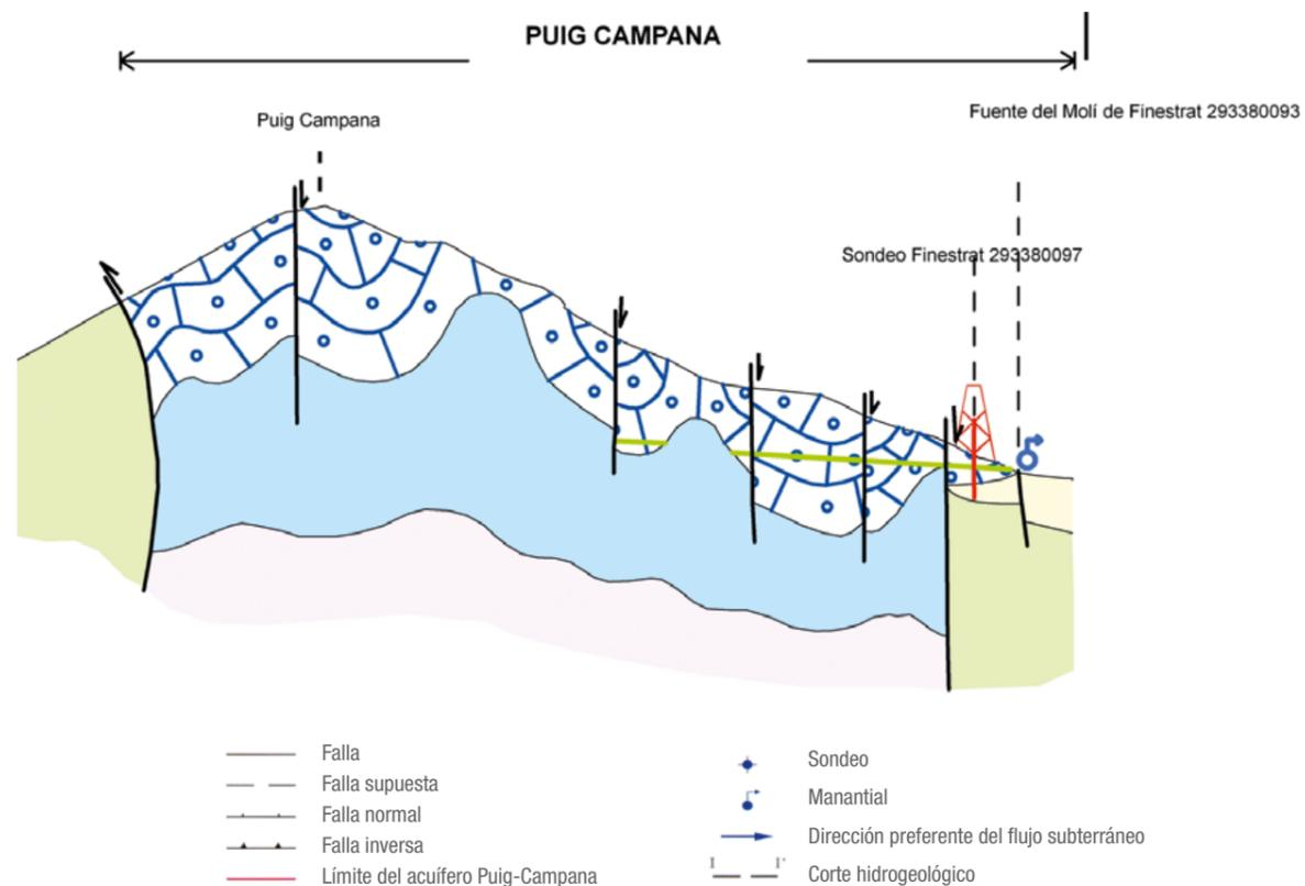
Figura 7.9. Mapa y corte hidrogeológico esquemático del acuífero Puig Campana (corte E-E' indicado en el Mapa de acuíferos)
