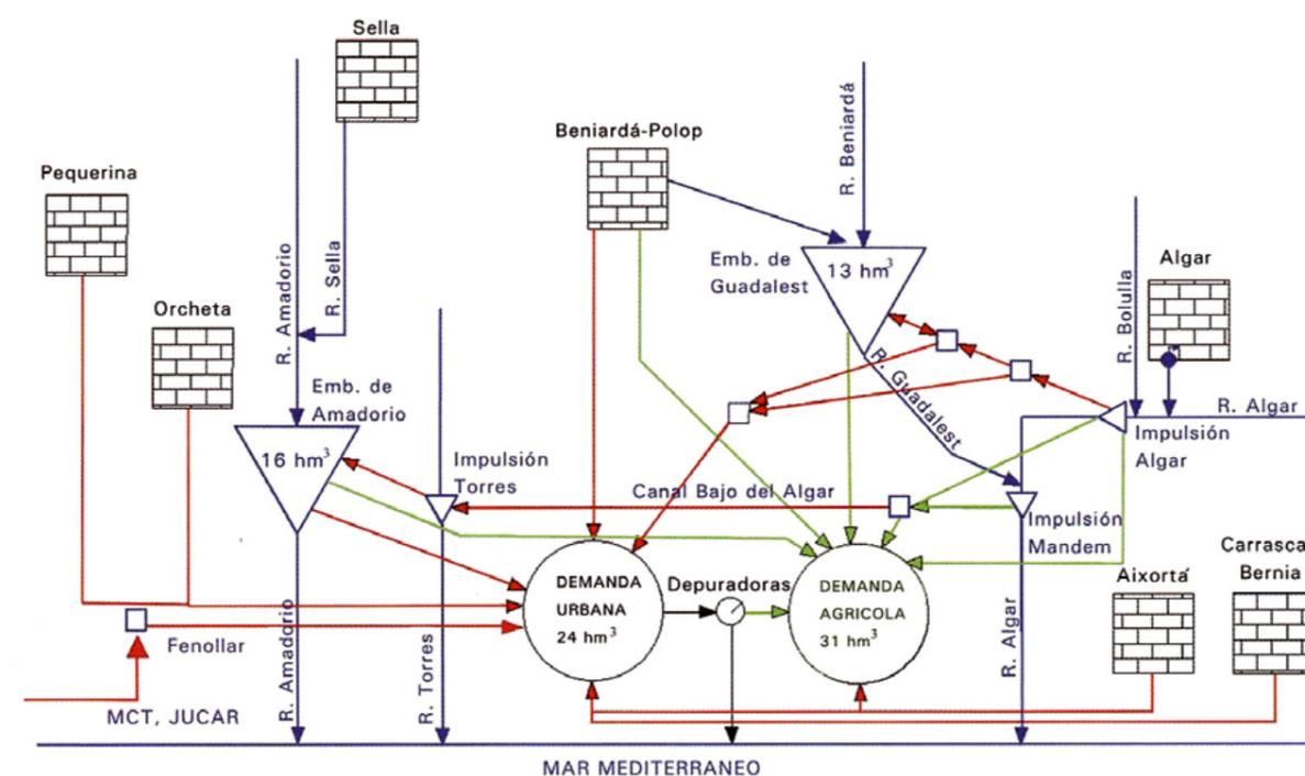
Figura 3.1. Esquema simplificado de uso conjunto de la Marina Baja
