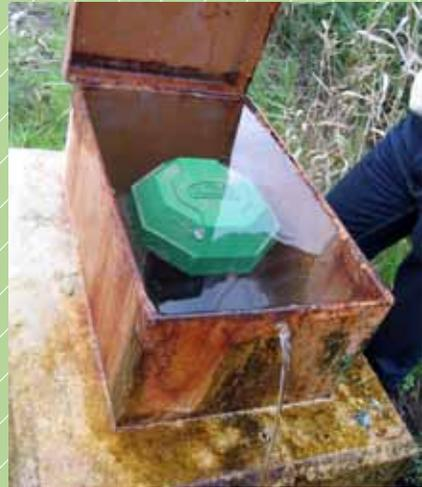
presión a que está sometida el agua de este nivel acuífero confinado. Sin embargo el piezómetro contiguo, de tan sólo 15 m de profundidad, alcanza un tramo permeable (acuífero) distinto, con otras características físico-químicas (diferente composición química y menor carga hidráulica) de forma que no llega a ser surgente. En ambas perforaciones se han instalado equipos para la toma continua de datos que permitirán un control preciso de las variaciones que se produzcan en las aguas subterráneas.
