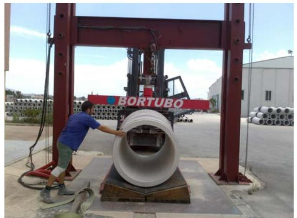
**Alineación zanja colector y prueba rotura aplastamiento tubo hormigón**
