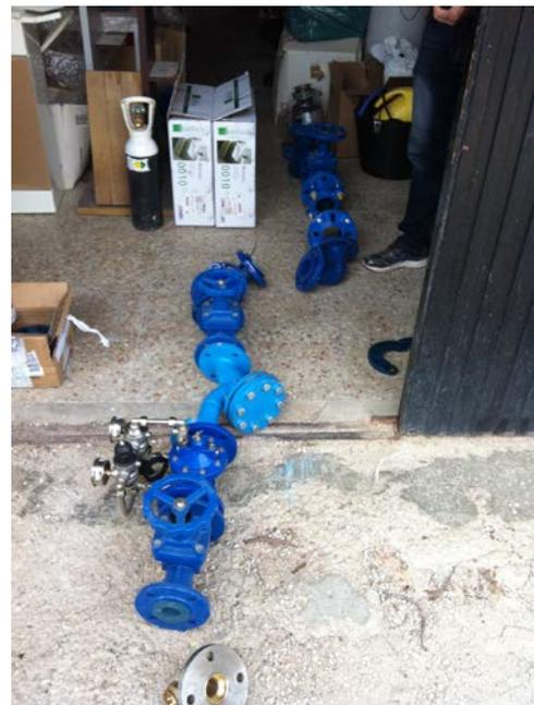
**Ventosa para evacuación de aire en la conducción, y valvulería y piezas especiales**
