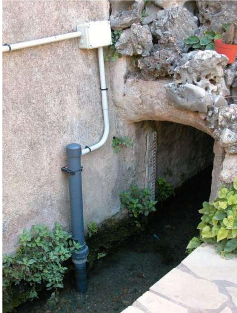
Manantial del Real Blanch en el que se aprecia la sección de aforo con la escala de control limnimétrico manual y la sonda para telemetría automatizada de caudales drenados instalada por Ciclo Hídrico de la DPA
